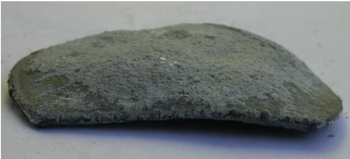
Deformazione del piombo dovuta all'idrocerussite
